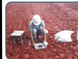
Método de Controle de Compactação Versátil, permite a verificação de camadas compostas por argila, silte, areia ou materiais pétreos. Utilizado em aterros, diversas camadas de Aterros, Pavimentos e Barragens.
