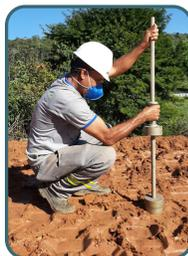
Método de Controle de Compactação rápido, que permite a verificação de compatibilidade entre parâmetros de campo e de laboratório. Executado em camadas de materiais finos componentes de Aterros, Pavimentos e Barragens.
