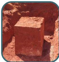
Para a execução de alguns ensaios especiais, é necessário que a coleta de amostras seja feita de uma forma específica e normatizada, sejam elas deformadas ou indeformadas. A Geotech Engenharia disponibiliza os serviços de coletas de materiais.
