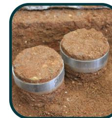
O ensaio de cisalhamento direto fornece os dados necessários para simulações de diversas geometrias de encostas e que permitem o cálculo do fator de segurança em cada situação. Com ele são determinados o ângulo de atrito e o intercepto coesivo do material.
